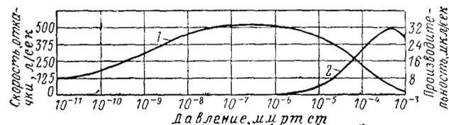
Рис. 2-14. Зависимость скорости откачки (1) и производительности (2) магнитно-электроразрядного насоса от давления.
